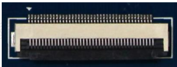
图 7 40pin FFC 连接器
