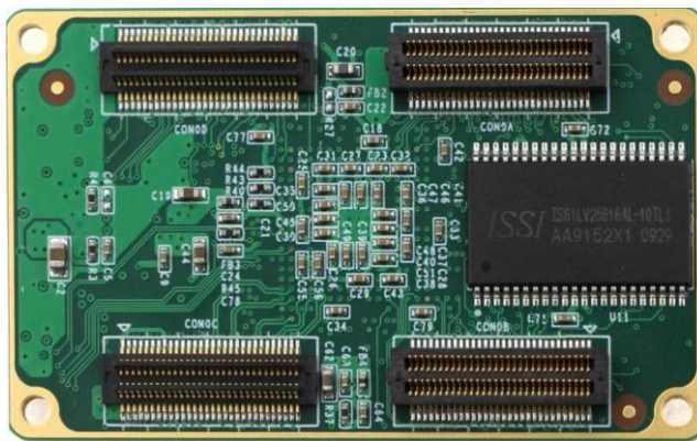
图 2 核心板背面图
