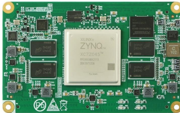
图 1 核心板正面图
