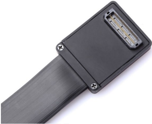
图 3 60pin MIPI 母座接口
