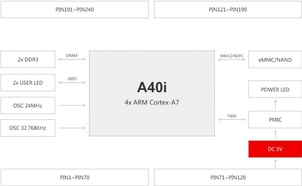
图 5 核心板硬件框图
