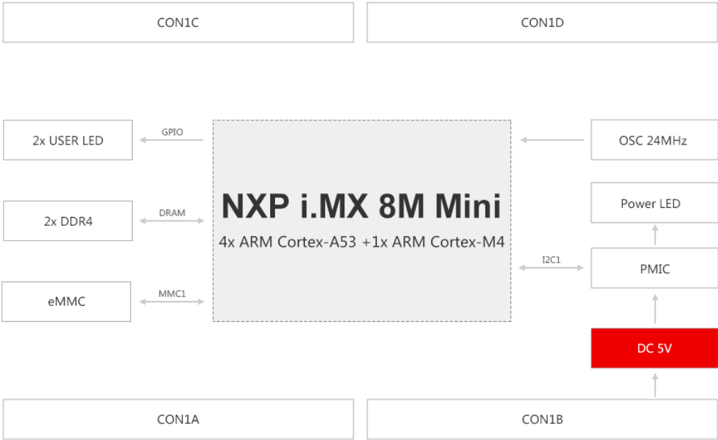
图 5 核心板硬件框图
