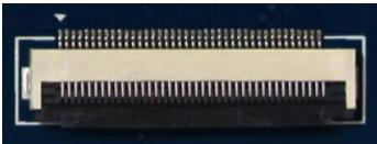
图 9 显示屏接口（40pin FFC 连接器，背面）
