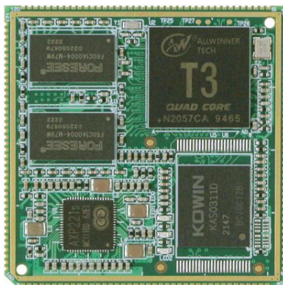
图 1 核心板正面图
