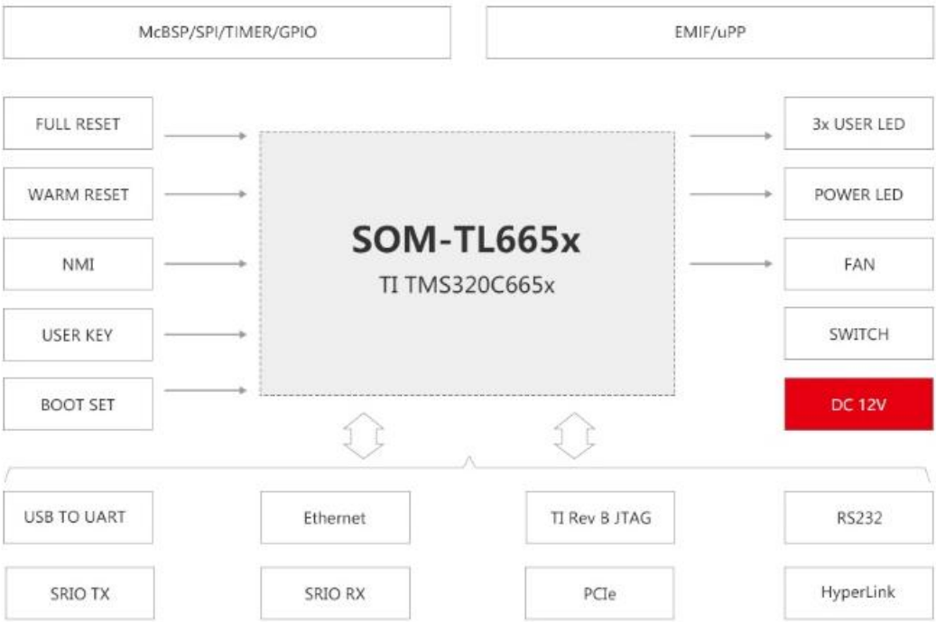
图 7 评估板硬件框图
